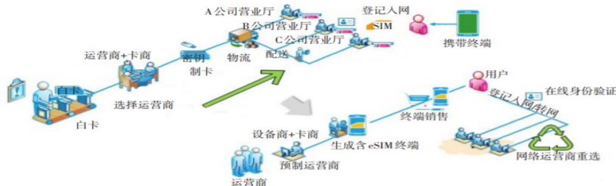
图33：传统SIM卡发卡流程与eSIM卡发卡流程
